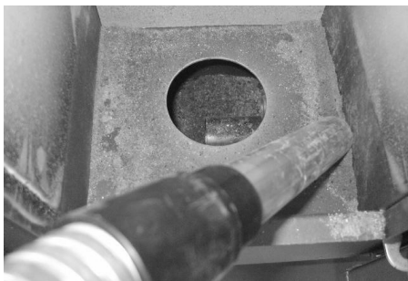
Fig. 31 - Reiniging ruimte aslade
