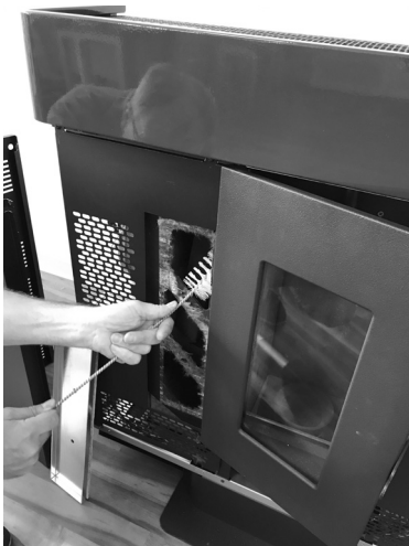
Fig. 37 - Reiniging met flessenwisser
