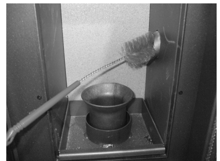
Fig. 33 - Reiniging met flessenwisser
